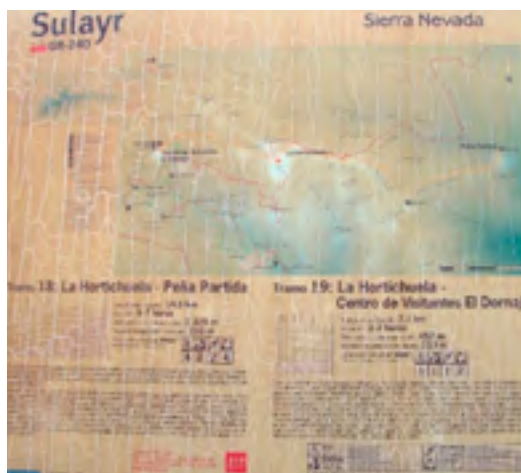
Vinilo sobre chapa de acero galvanizado. Después de 4 años.
